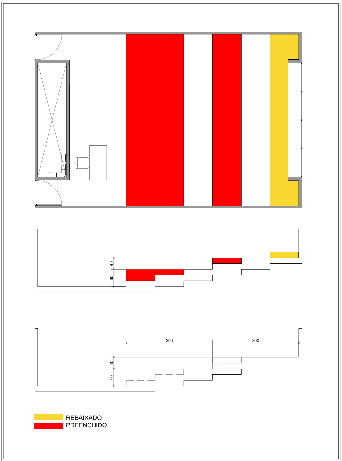
DETALHE - AJUSTE DE NVEL DO 2º PAVIMENTO
