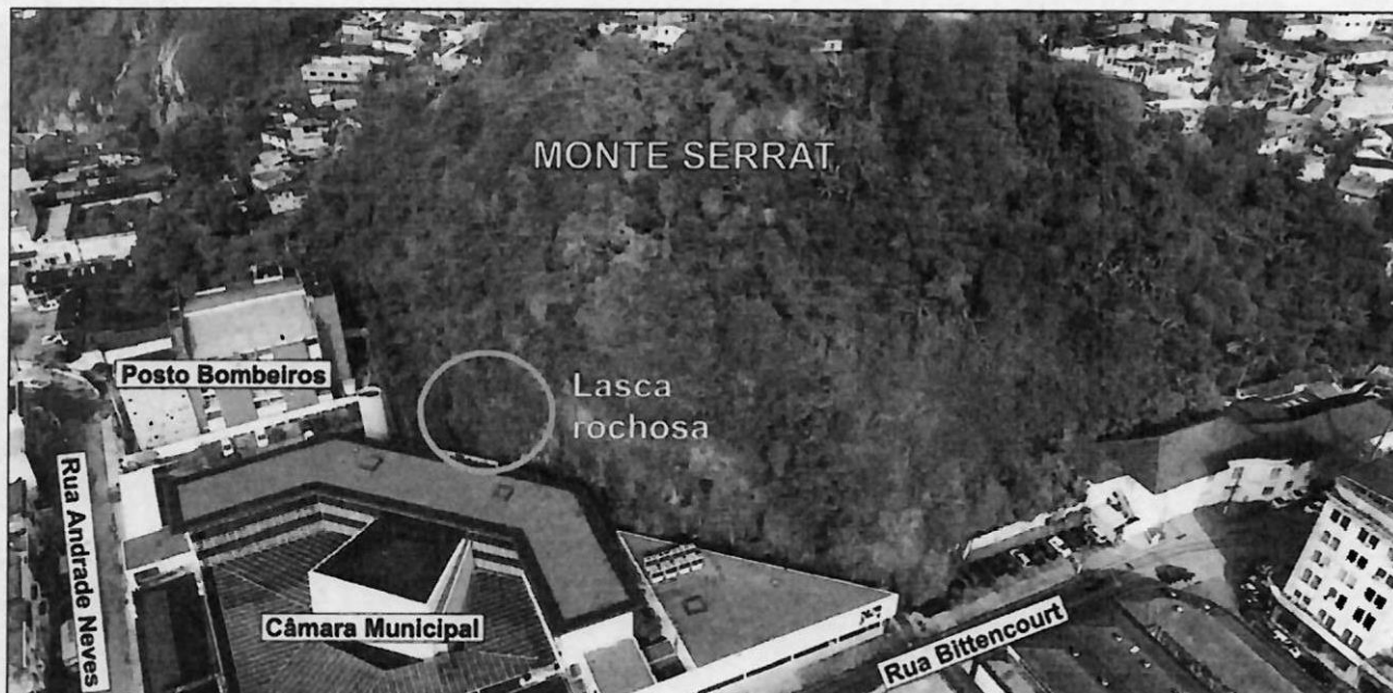
Figura 1 – Foto de junho de 2018 mostra localização de lasca rochosa com risco de queda no trecho de encosta do Monte Serrat aos fundos da Câmara Municipal. Notar proximidade entre a edificação e o paredão rochoso.
